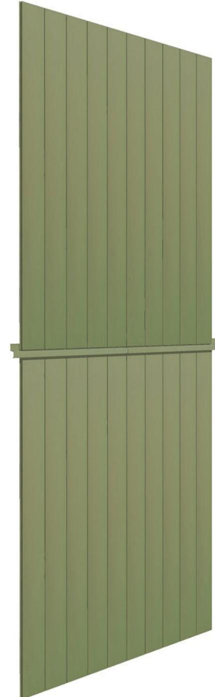
*Détail de bardage avec combinaison horizontale et verticale.*
