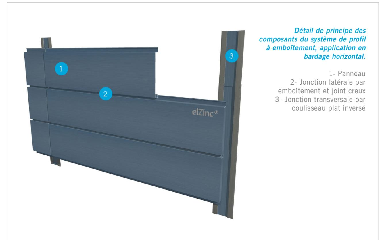
**Détail de principe des composants du système de profil à emboîtement, application en bardage horizontal.**
